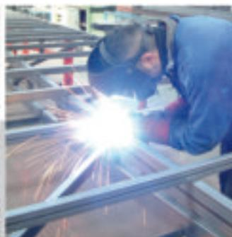
Chasis reforzado realizado en acero galvanizado tipo E-220+Z-275-NAC de gran resistencia a la intemperie y ambientes salinos. (fabricado según norma europea UNE-EN10305-5)
